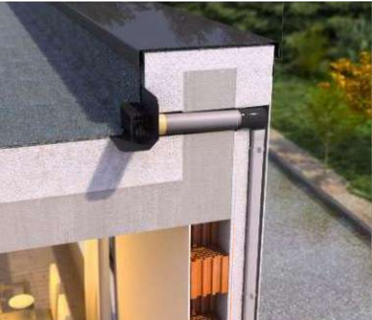
СХЕМА РОЗМІЩЕННЯ ДОЩОПРИЙМАЧА ТА ВЛАШТУВАННЯ РИНВИ В ТОЩІ УТЕПЛЮВАЧА
